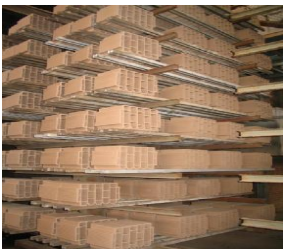
شکل (۱-۲) آجر سفال در حال خشک شدن
