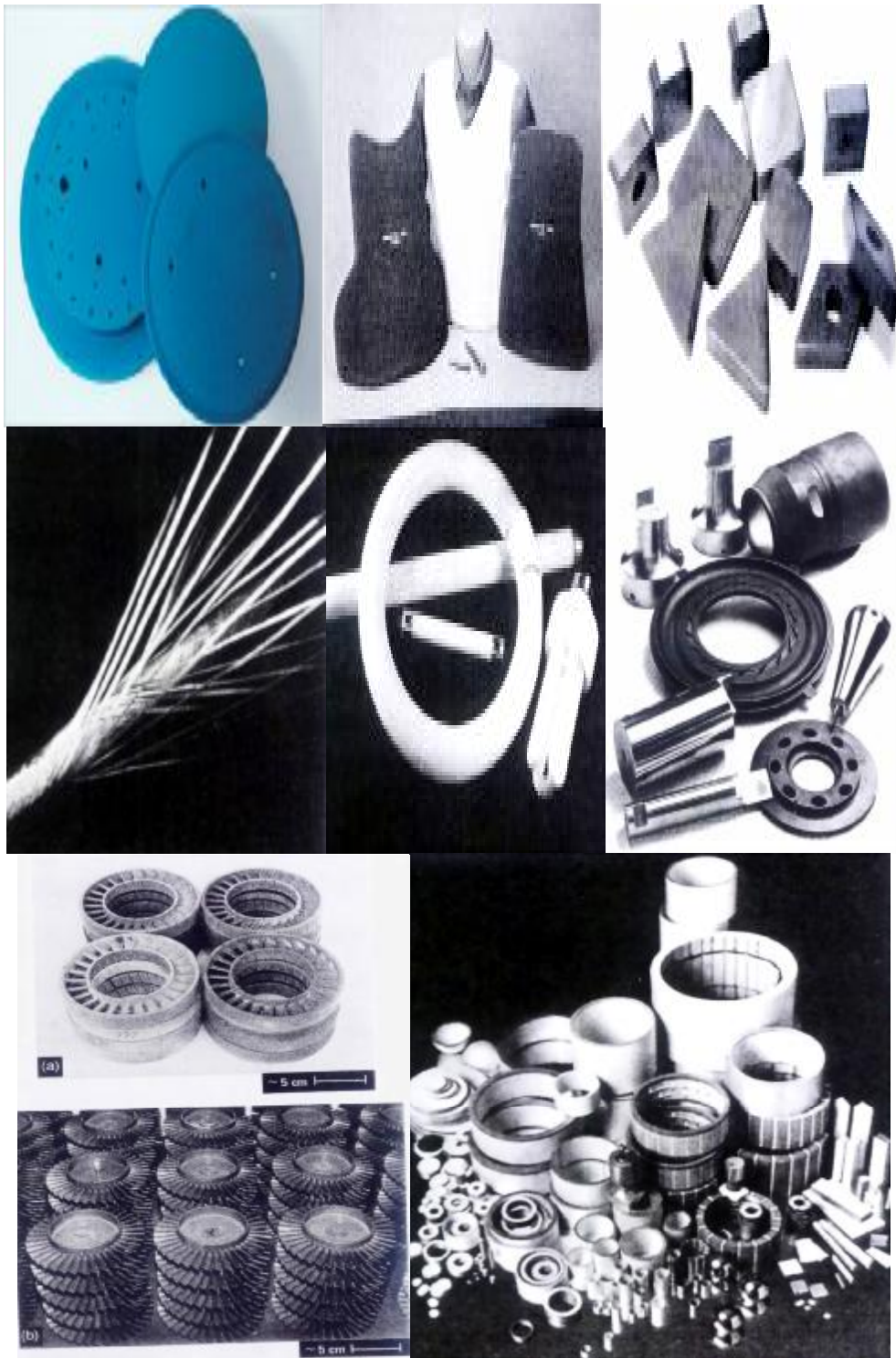
شکل (۶) ابزار تراش، جلیقه ضدگلوله، فیلتر سرامیکی، قطعات سیلیکون کاربید، لامپ، رشته ابررسانا، دی الکترونیکها، قطعات ماشین
