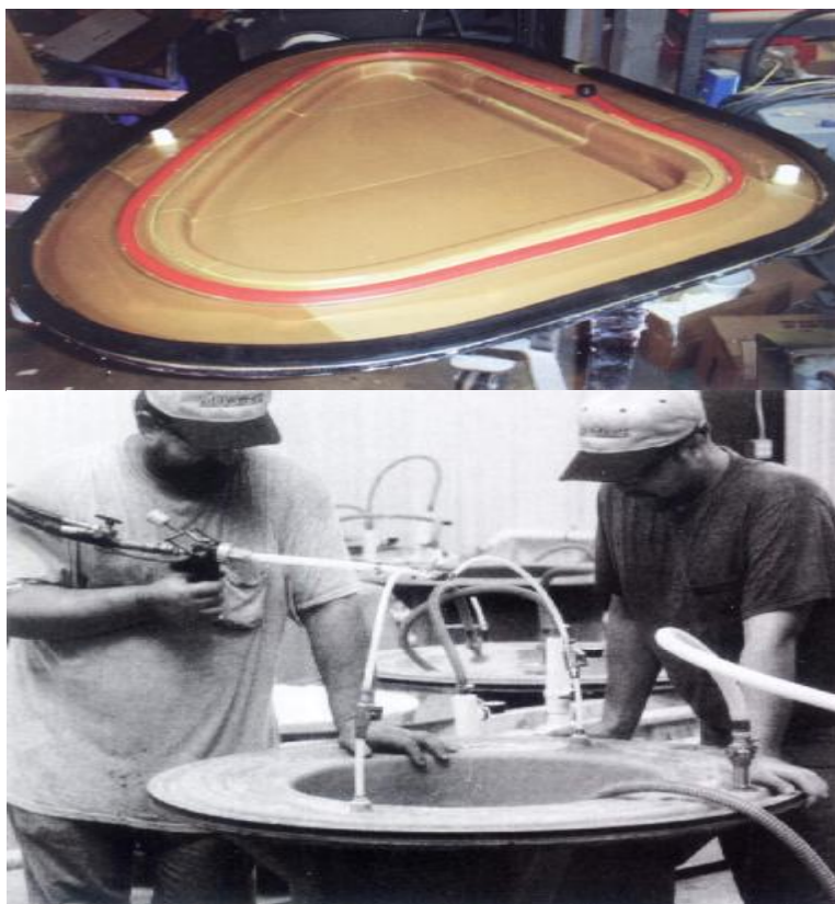
شکل (۳-۹) قالب رزینی تزریقی (RTM)
